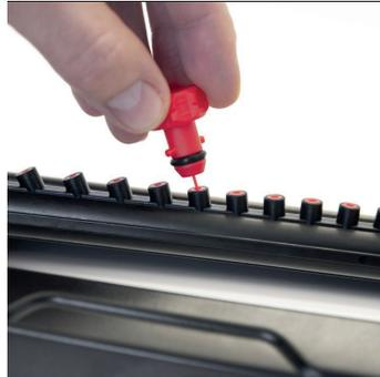
Reinigung der Sprühdüsen, mithilfe der Reinigungsnadel
